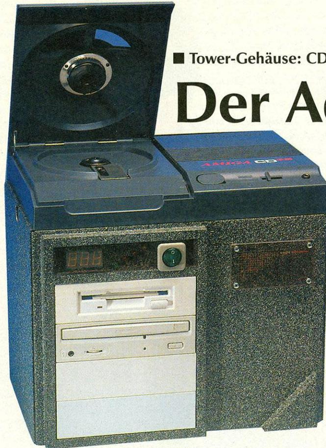
sich das CD<sup>32</sup> über ein Adapterkabel direkt vom Netzteil des Towers. Ein Ein-Ausschalter an der Gehäusefront schaltet die gesamte Einheit.
