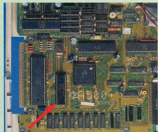
**3** Merken Sie sich die Lage der ROMs genau. Nehmen Sie sich die Zeit und fertigen Sie sich eine Skizze an, denn ein falscher Einbau zerstört fast immer das ROM!
