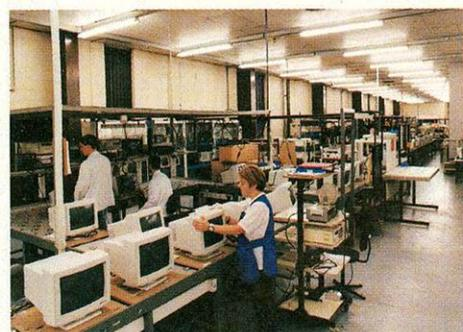
**Monitore am laufenden Meter: Endmontage der Gehäuse und Abschlußprüfung mit Farbwerteinstellung**
